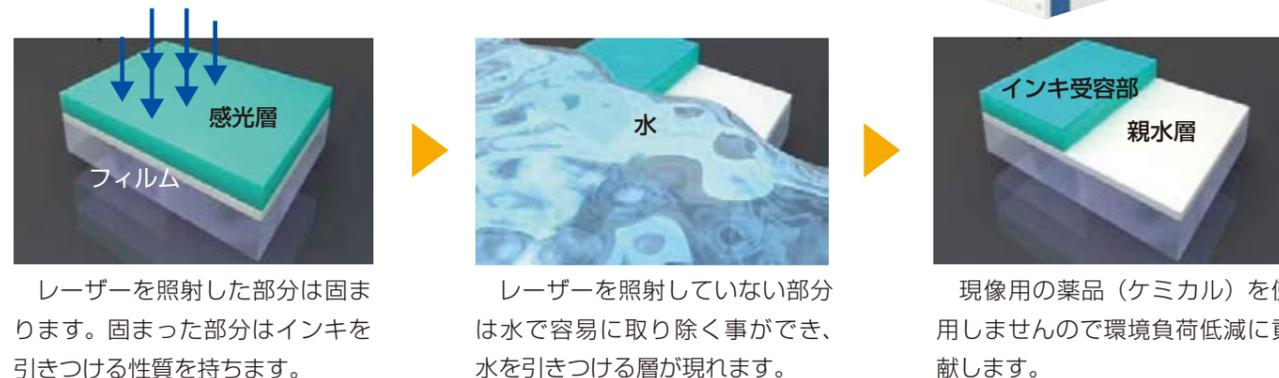
レーザーを照射した部分は固まります。固まった部分はインキを引きつける性質を持ちます。
