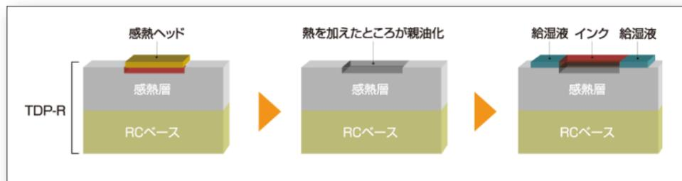
感熱ヘッドの熱により、版の表面がインキを引きつけるように変化します。
