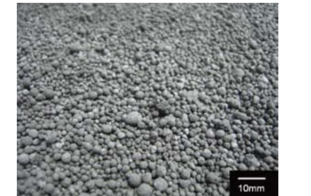
路盤材、埋戻材、防草材などに使用されています。
