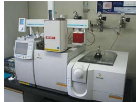
熱分解ガスクロマトグラフ質量分析計
