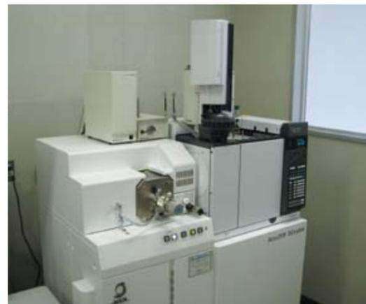
ガスクロマトグラフ飛行時間型質量分析計
